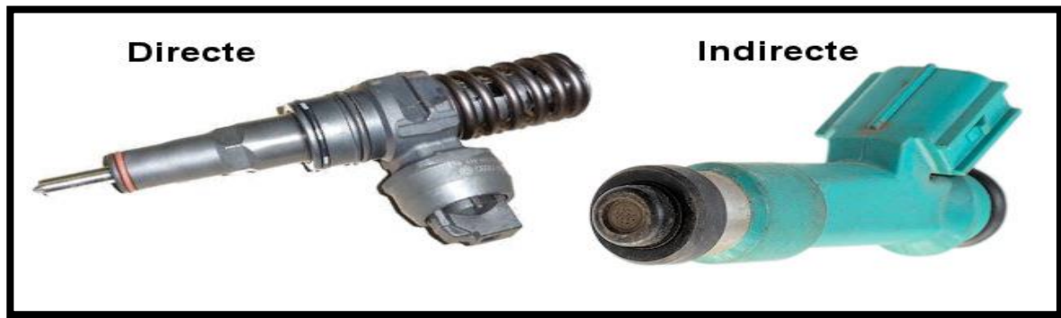
Figure I.5 : Injection directe et indirecte [4].
