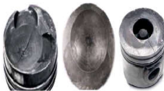
Figure I.18 Fissures diverses à la tête de piston [18]
