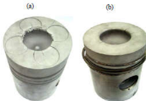
Figure I.20 Têtes endommagées de pistons de locomotive : (a) Piston 1 (b) Piston 2 [19]
