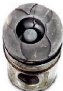
Figure I.17 Tête de piston fissurée [16]
