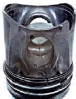
Figure I.19 Piston cassé jusqu'à l'axe [19]
