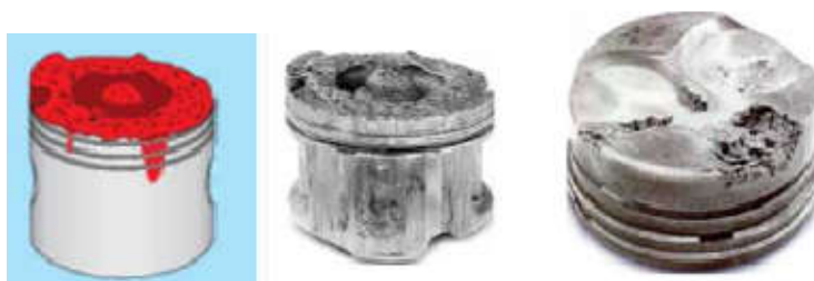
Figure I.16 Tête de piston endommagée[17] [16]
