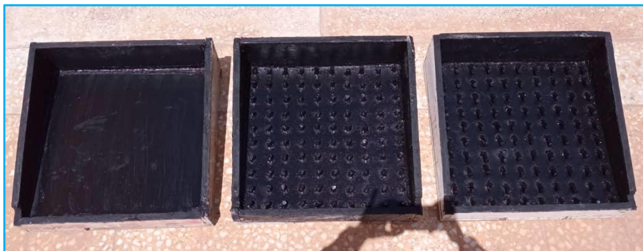
الشكل (III-12): صورة للمقطرات الشمسية الثلاثة (الشاهد- المحسن بالزعانف العمودية- المحسن بالزعانف المائلة).
