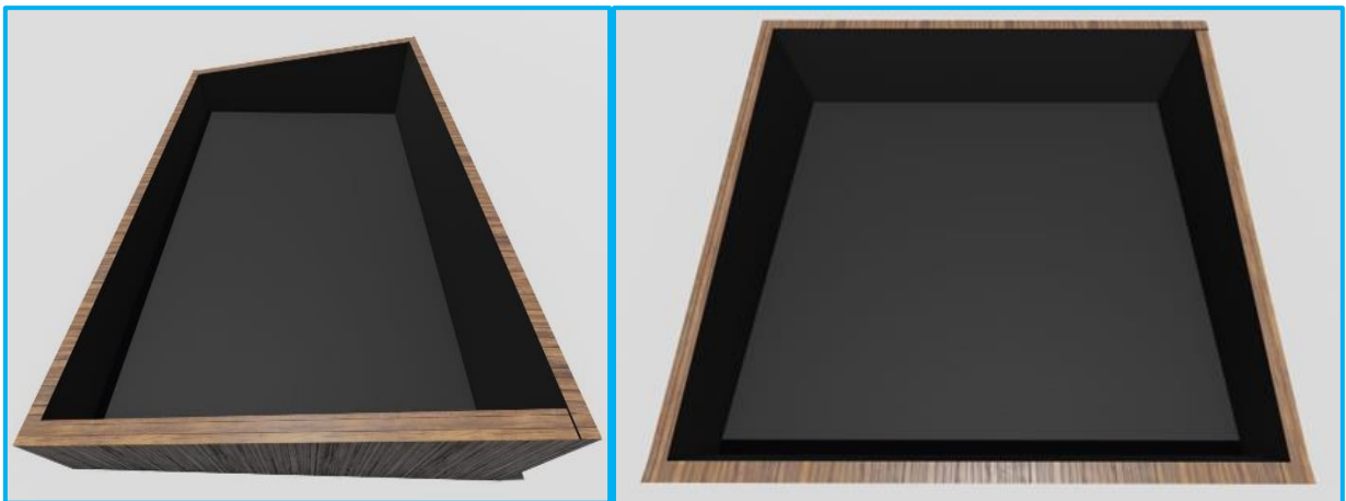
الشكل (9-III): رسم ثلاثي أبعاد يوضح المقطر الشاهد.
