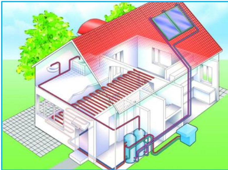
الشكل (I-14): نظام التدفئة الشمسية في المنازل.
