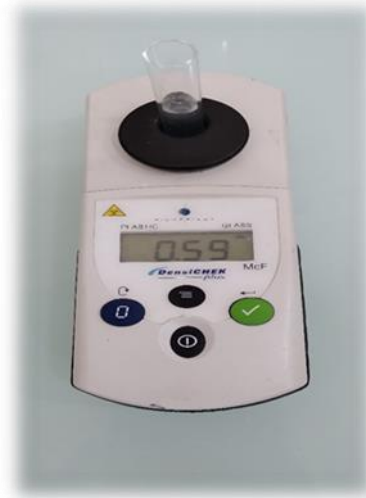
الملحق 6 : جهاز قياس كثافة البكتيريا
