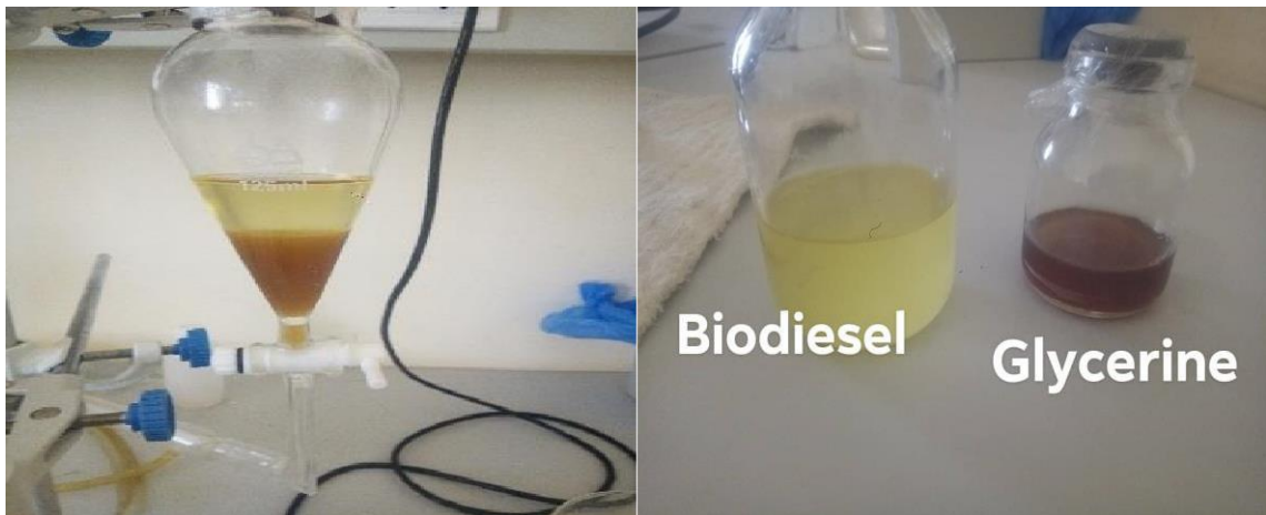
Figure 2.12 : installation et séparation des phases.
