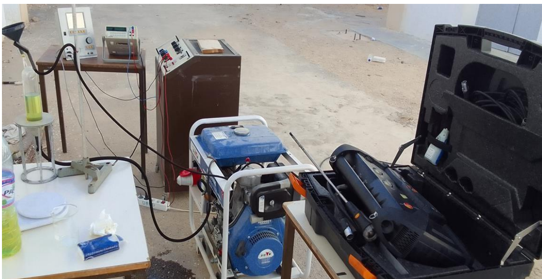
Figure 4.2 (a) Banc d'essai de la valorisation du biodiesel
