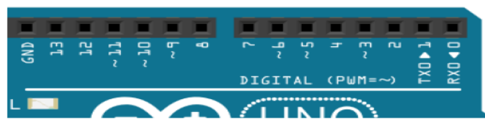
Figure.IV.6 Les entrées / sorties numériques.
