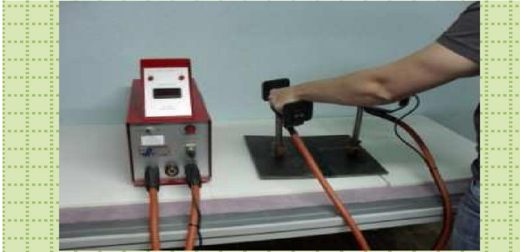
Figure I.12 aimantation par générateur
