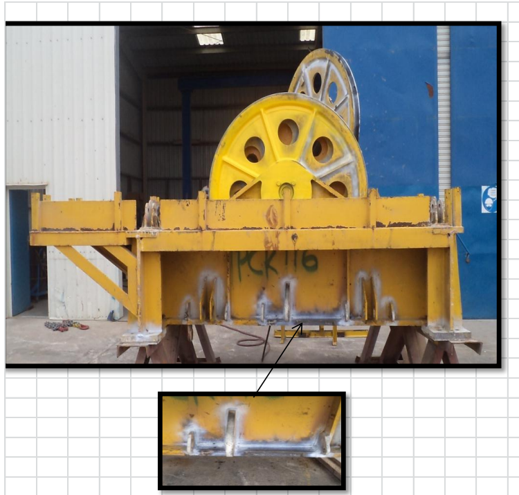
Figure III.8 : moufle fixe après inspection magnétoscopique
