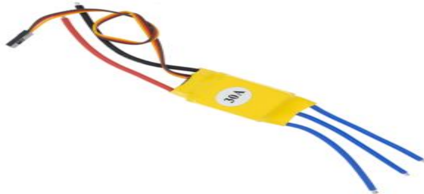
Figure (III.2) : Variateur de vitesse ESC 30A.
