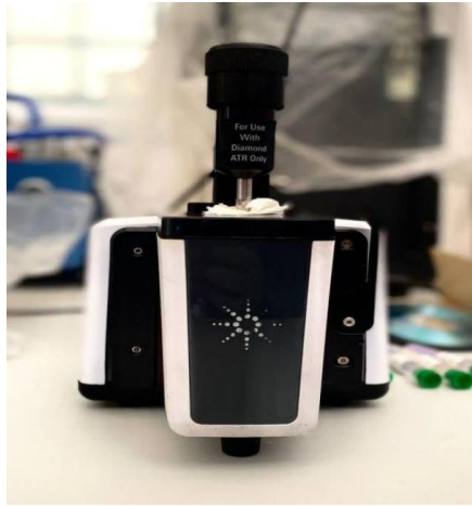
الشكل (III-8): صورة توضح جهاز الأشعة تحت الحمراء FTIR
