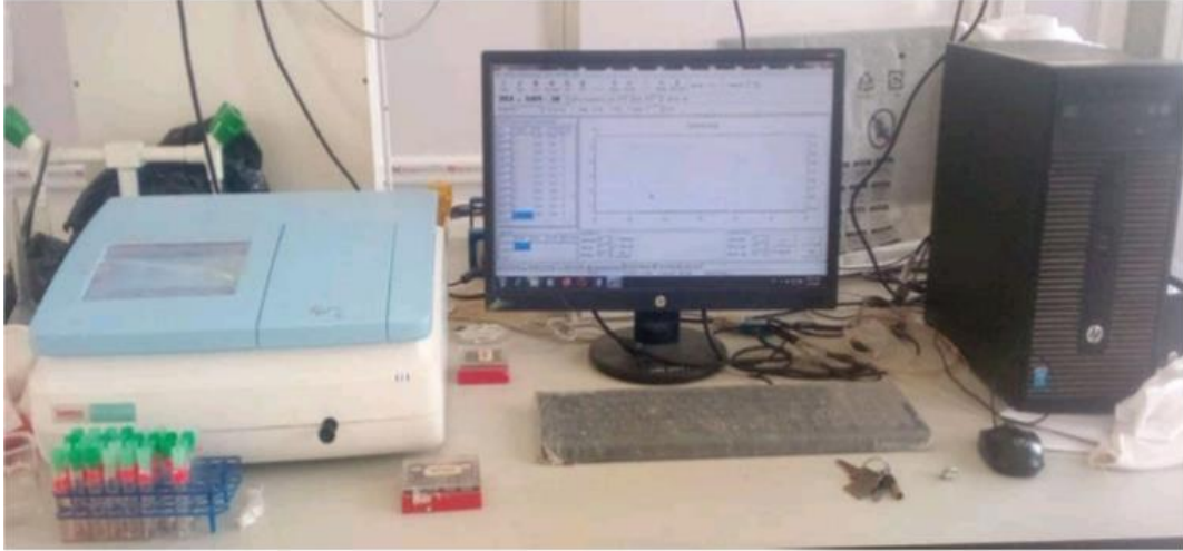
الشكل (III-10): صورة توضح جهاز مطيافية الأشعة البنفسجية
