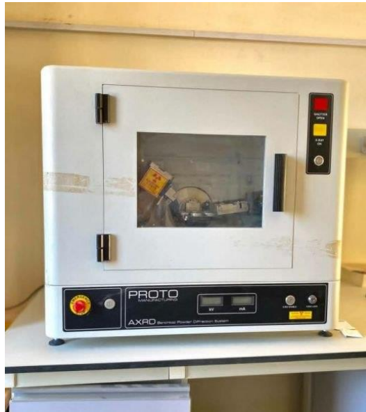
الشكل (III-7): صورة توضح جهاز الأشعة السينية XRD
