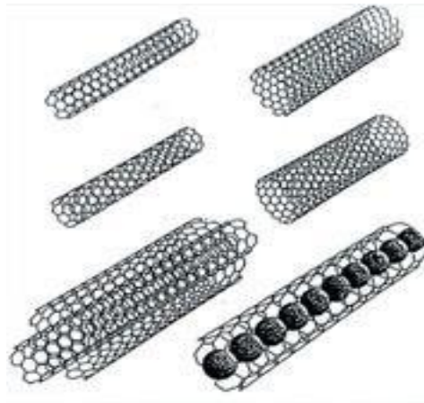
الشكل (10-I): صورة توضح الأنابيب النانوية الكربونية [51]
