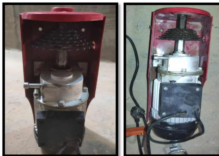
Figure III. 6 Installation de la chaîne et des engrenages avec le moteur.
