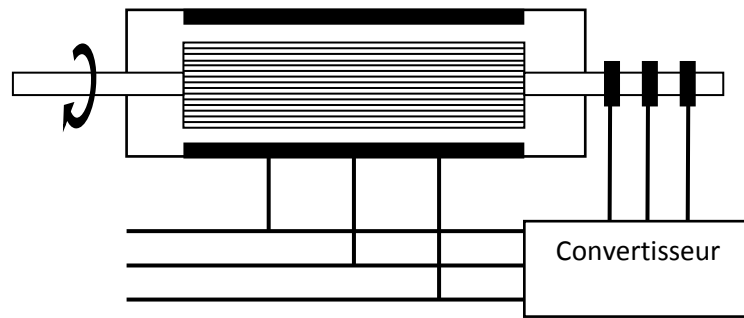
Figure I.2 Schéma de mada par système balais-bague
