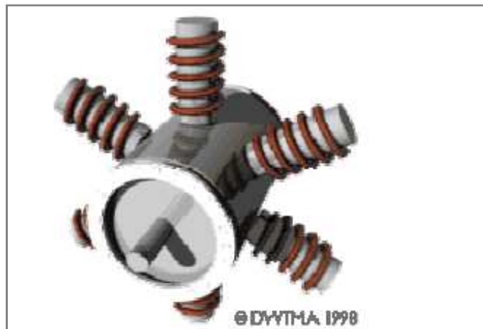
Figure III.13 : Schéma d'une génératrice asynchrone
