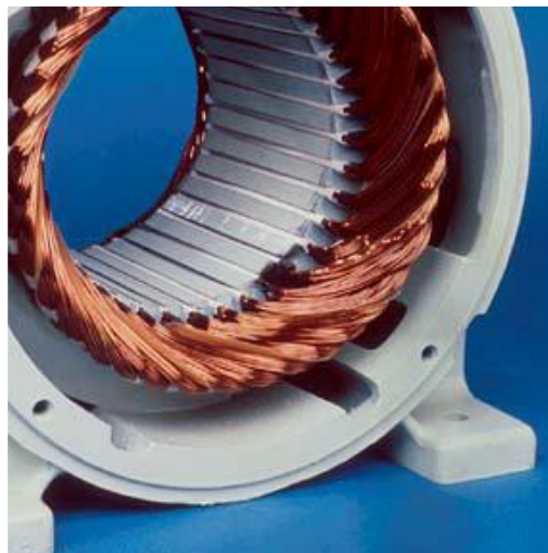
Fig. I.2. Stator après bobinage
