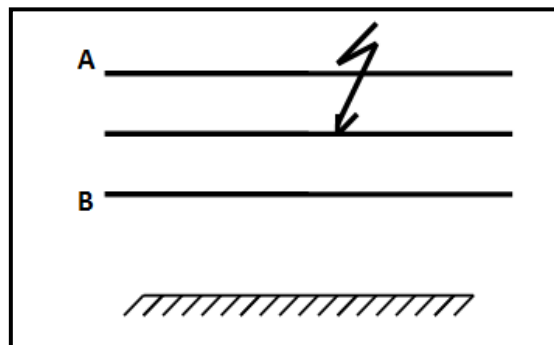
Fig. II-15:cas d'un court-circuit biphasé simple
