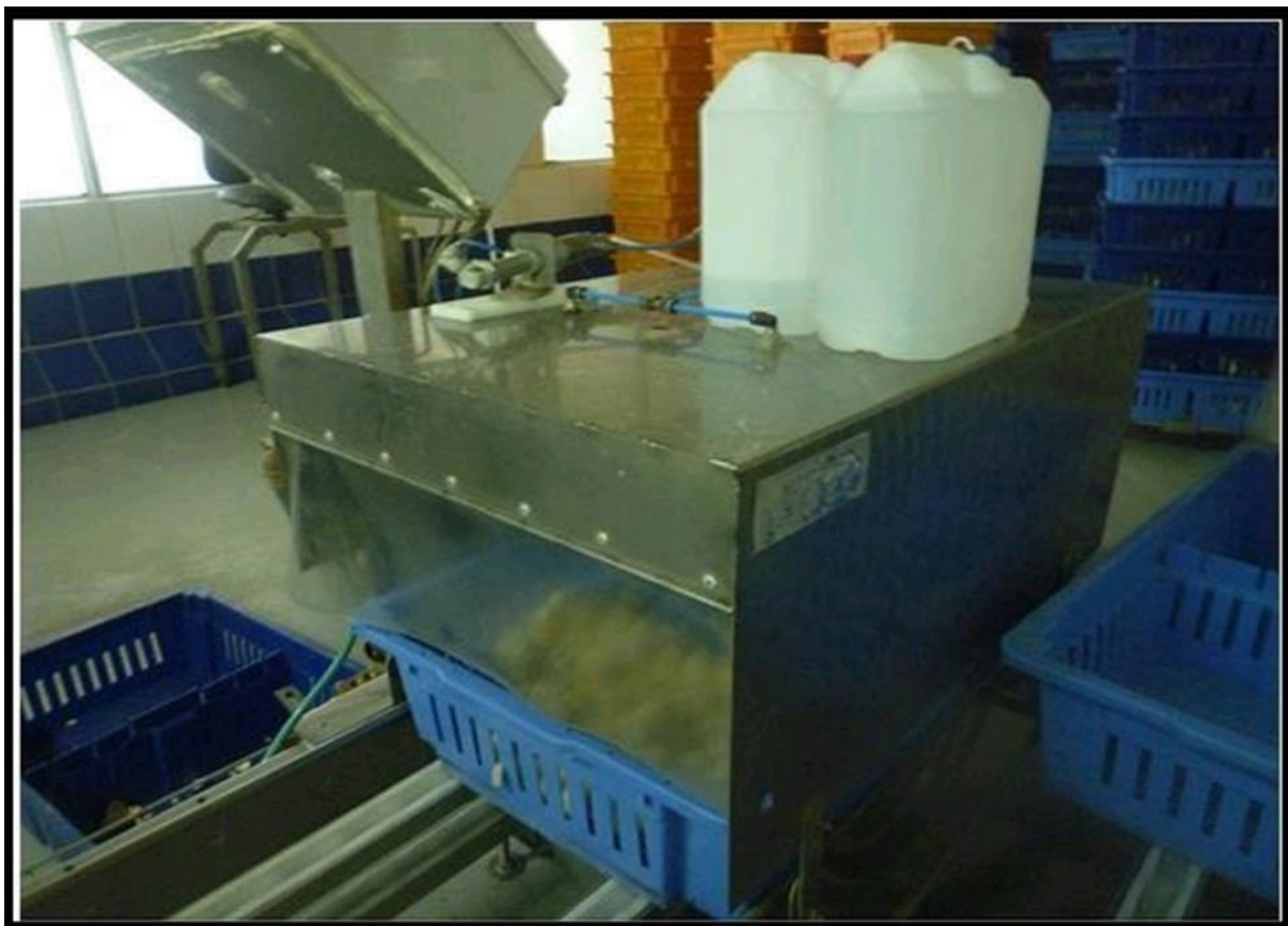
Figure5: Boite de pulverisation pour la vaccination contre la bronchite infectieuse des poussins Dun jour au covrir )Guerin et al. ,2023 (
