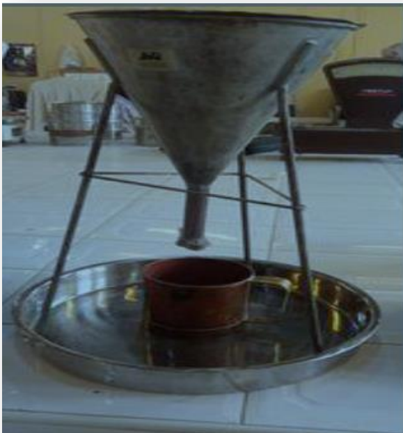
Figure III.3 Mesure de la masse volumique apparente.
