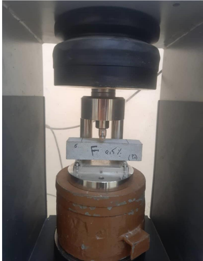
Figure IV.2 Description d'essai de traction par flexion.
