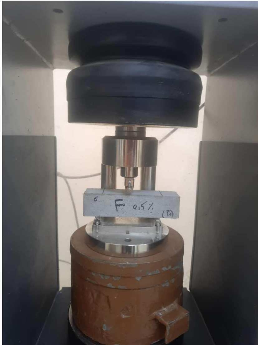
Figure IV.1 Description d'essai de compression.
