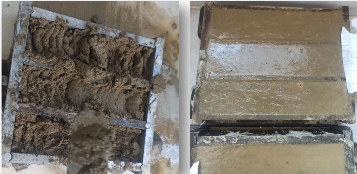
Figure III.10 Fabrication et moulage des éprouvettes.
