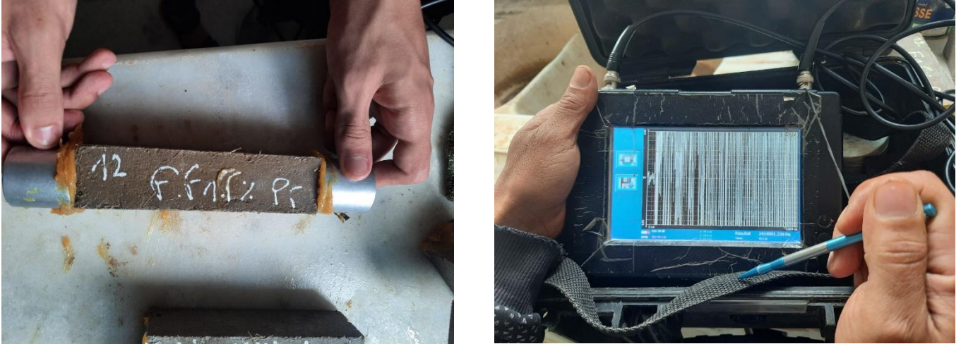
Figure IV.4 Description d'essai de la mesure de la vitesse de son.
