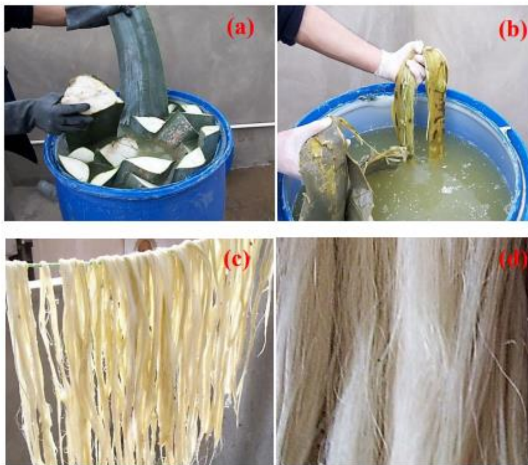
Figure II.14 Différentes étapes de la méthode d'extraction de la fibre. (a) Les lames plongées dans l'eau ; (b) biodégradation des fibres après 15 à 21 jours à température supérieure à 25°C ; (c) fibres lavées à l'eau et séchées à l'air et au soleil ; (d) fibres finales obtenues. [53]
