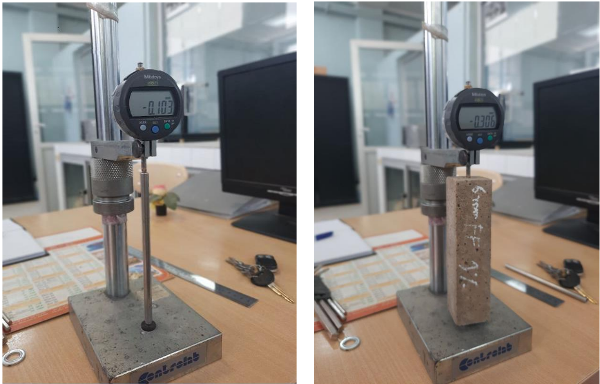
Figure IV.3 Description d'essai de mesure du retrait.
