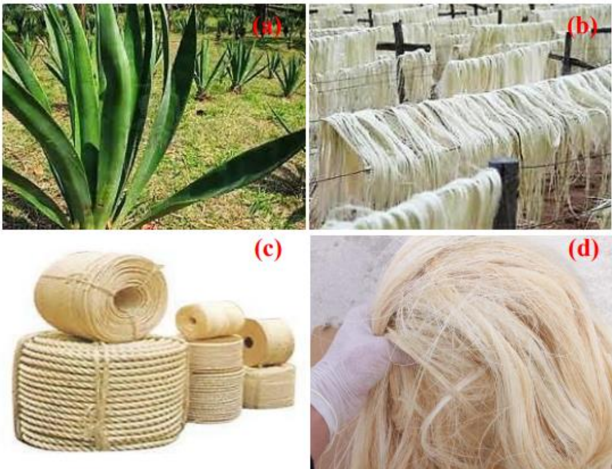
Figure II.13 (a) Plante de sisal, (b) fibre extraite de la plante, (c) cordes fabriquées à partir de la fibre de sisal et (d) fibre de sisal utilisée dans ce travail. [53]
