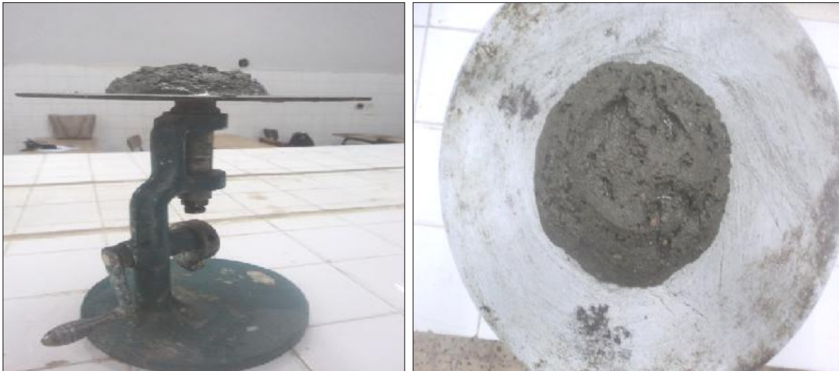
Figure III.12 Essai d'étalement à la table à secousses.
