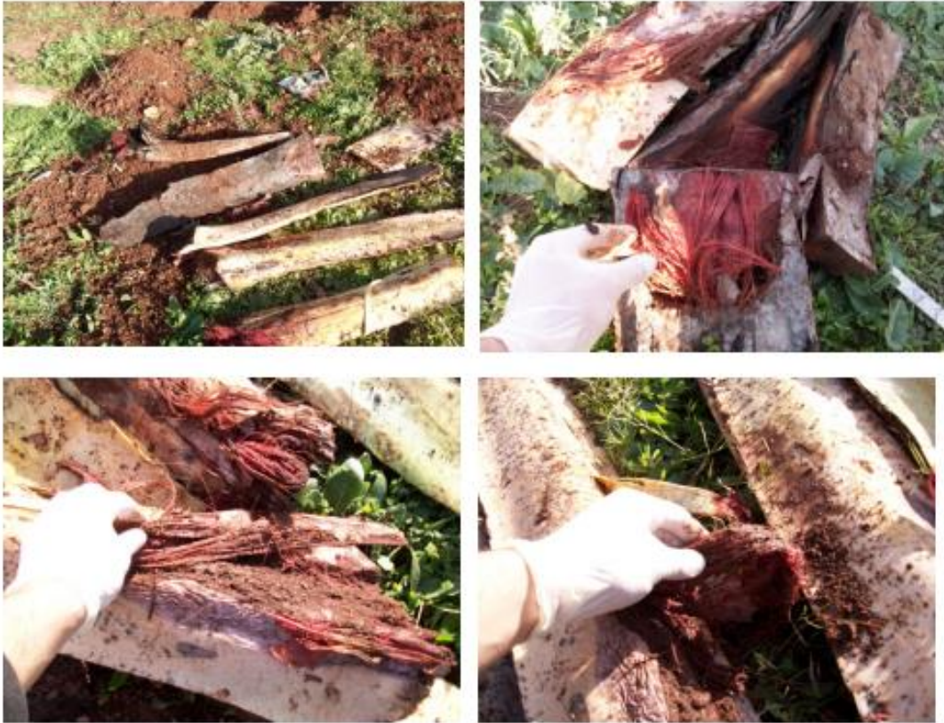
Figure II.15 Lame après 90 à 100 jours de l'enfouissement. [55]
