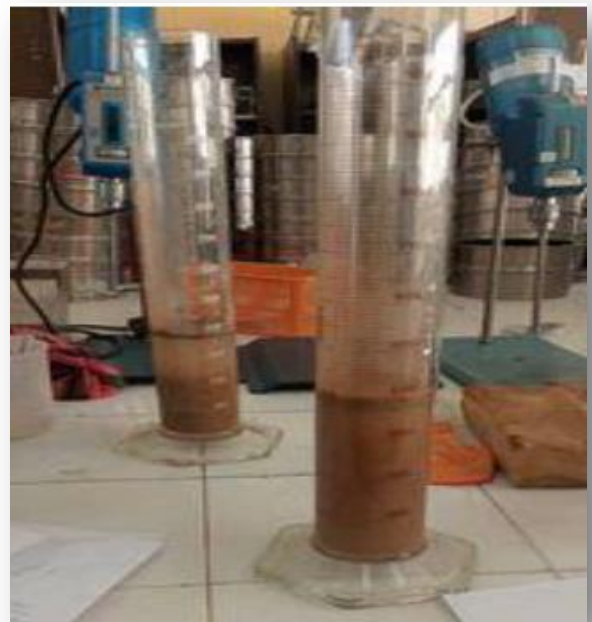
Figure III.4 Mesure de la masse volumique absolue.
