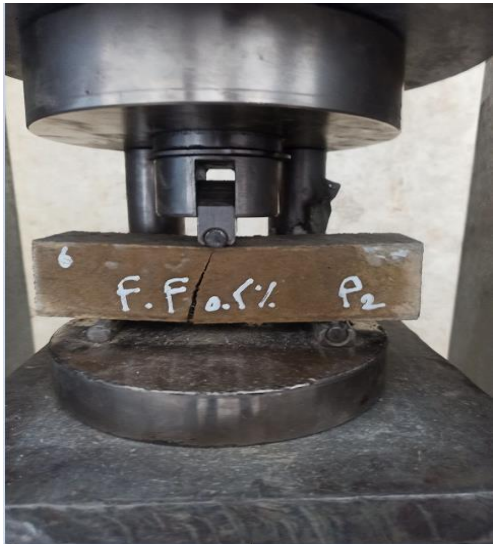
Figure IV.21 Mode de rupture du béton de sable témoin.
