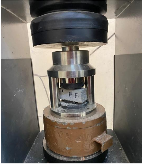
Figure IV.21 Mode de rupture du béton de sable témoin.
