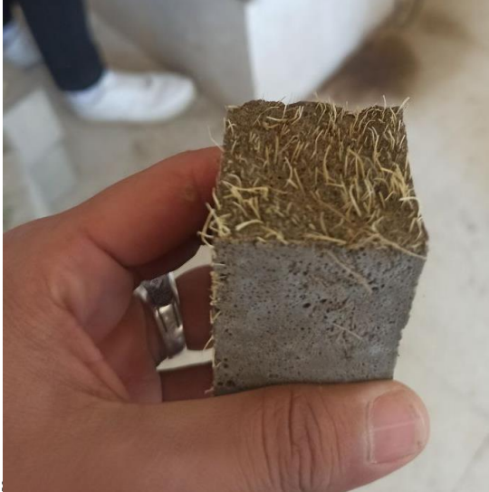
Figure IV.21 Mode de rupture du béton de sable témoin.
