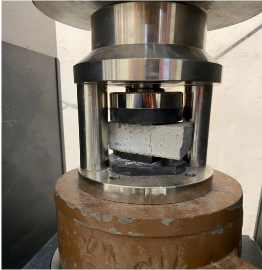
Figure IV.21 Mode de rupture du béton de sable témoin.
