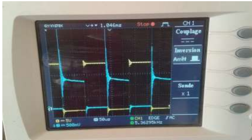
Figure.IV.21 : Allure réel de la tension et du courant de diode.
