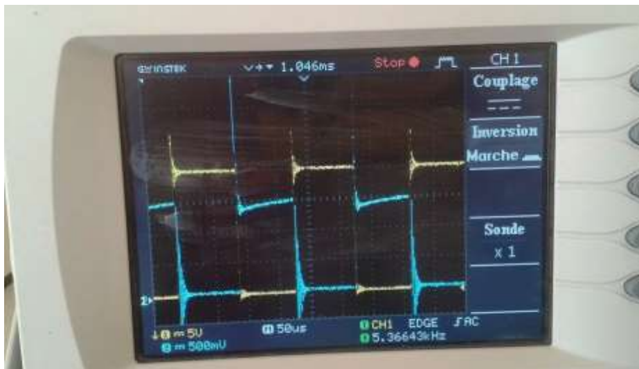
Figure IV.20 : Allure réel de la tension et du courant de transistor.
