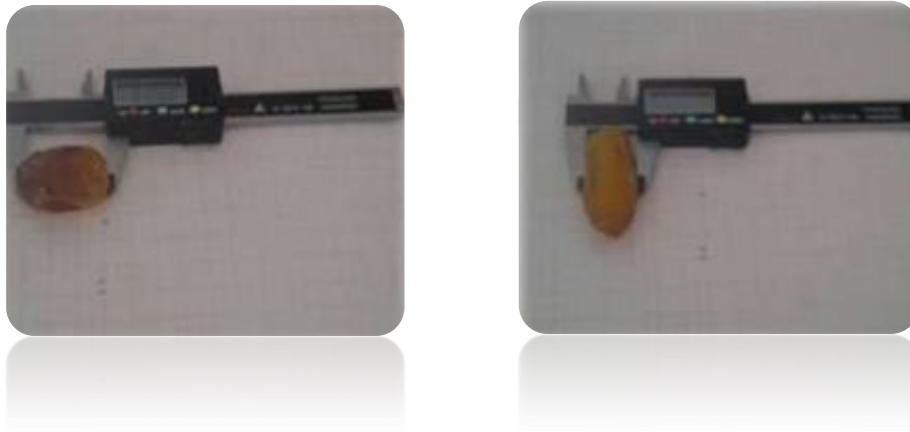
Figure: Mesure du diamètre et de la longueur d'un fruit à l'aide de pied à coulisse
