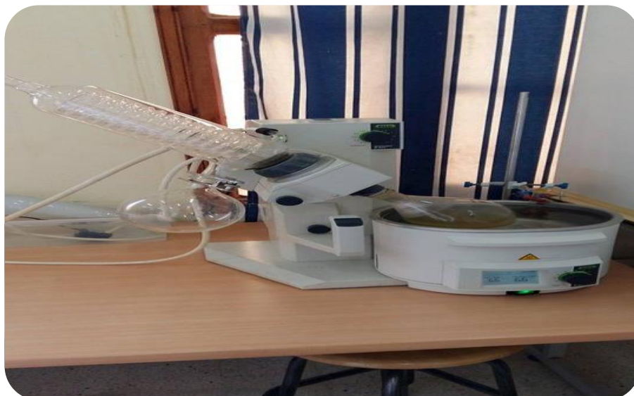
Figure. IV.3: Obtention de sirop de sucre brut par le rotavap
