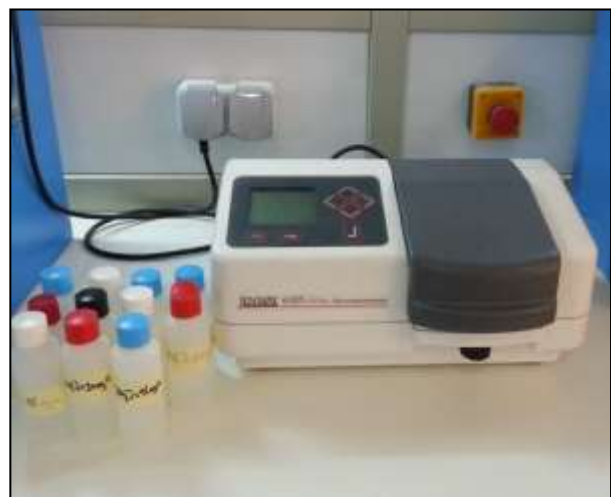
Figure 17: Spectrophotomètre utilisé pour le dosage des nitrates.
