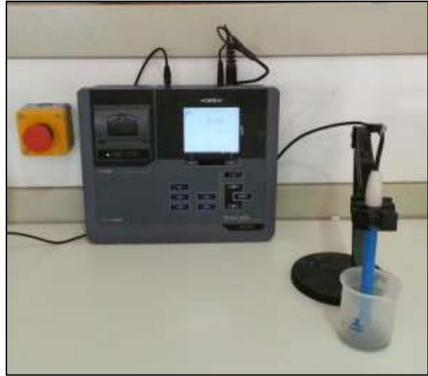
Figure 18: pH mètre utilisé pour mesuré le pH des échantillons.
