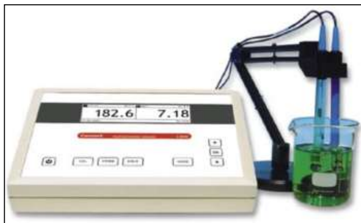
Figure 21: Multi-paramètre utilisé pour le dosage des ions chlorure ( \text{Cl}^- ) des échantillons.
