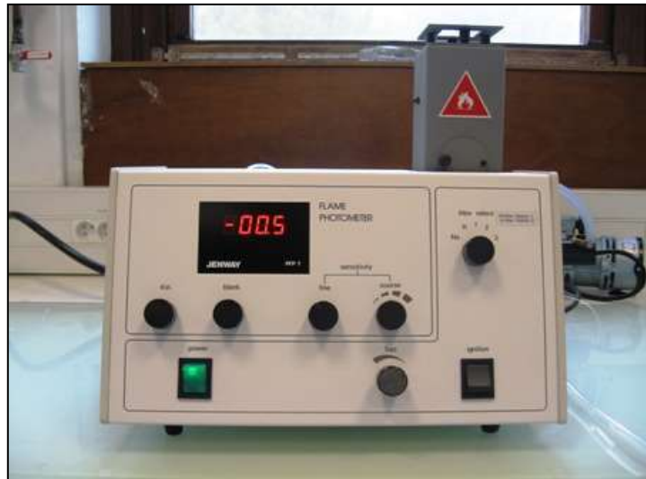
Figure 20: Spectrophotométrie à flamme utilisée pour le dosage des ions ( \text{Na}^+ , \text{K}^+ ) des échantillons.
