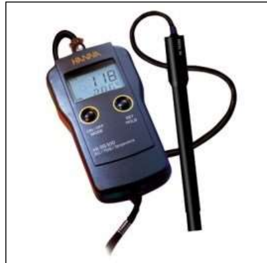
Figure 19: Conductimètre électrique utilisé pour mesuré la conductivité ( \mu\text{s}/\text{cm} ) des échantillons.
