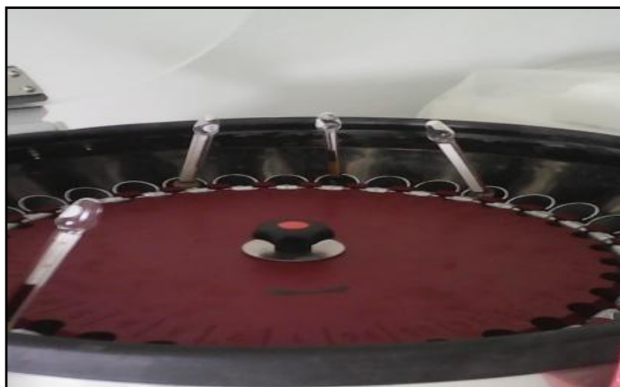
Figure 23: Centrifuger les mélanges (l'acide sulfurique, le lait et l'alcool) durant 5 min dès que la vitesse requise est atteinte ( photo personnelle, 2017 )
