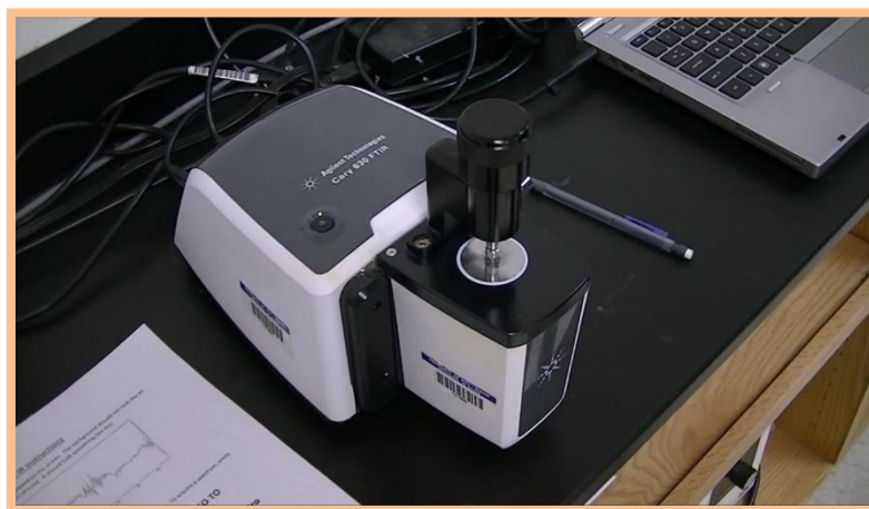
شكل (IV-8): جهاز طيف الأشعة تحت الحمراء بتحويل فورييه (FTIR).
