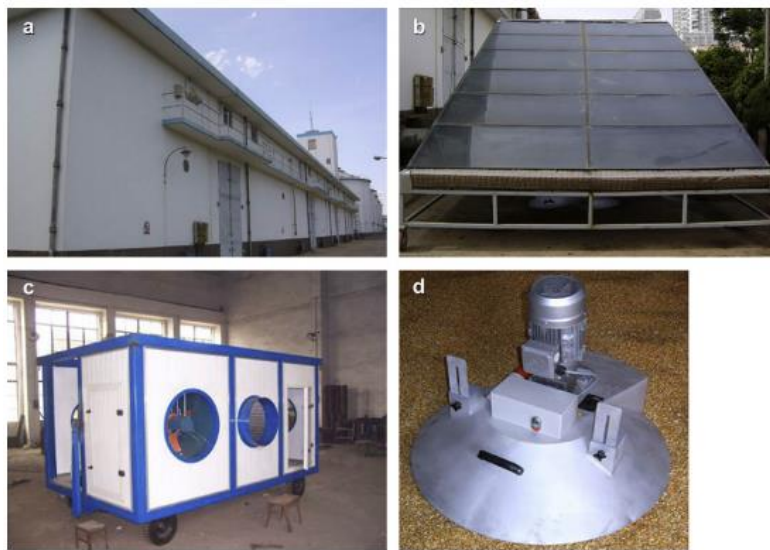
Figure I-14: Le grenier (a), les capteurs solaires (b), la pompe à chaleur (c) et l'agitateur à grains (d) utilisés dans le système de démonstration
