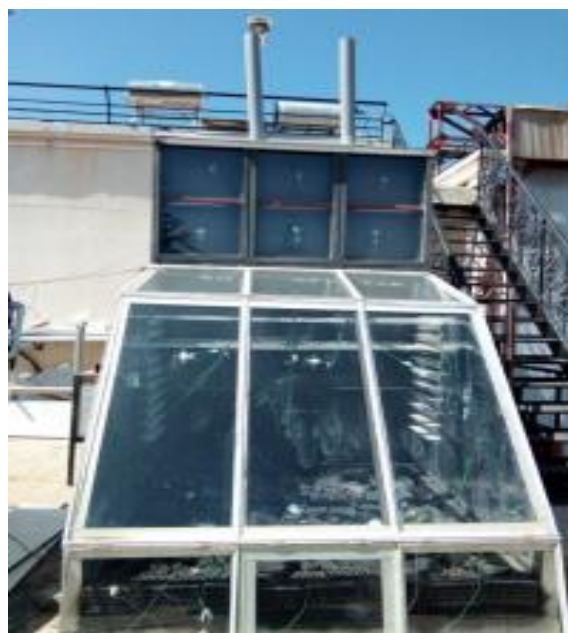
Figure I-4: Séchoir solaire directe (serre) avec tubes d'évacuation supplémentaires[6]
