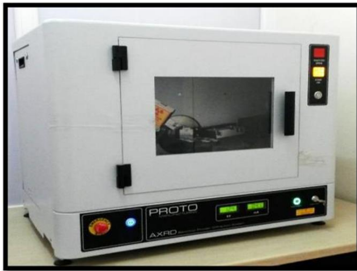
الشكل (25): جهاز انعراج الاشعة السينية المستخدم [47]
