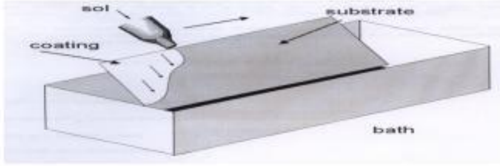
الشكل (21): رسم تخطيطي يوضح عملية التغطية بالتدفق [41]
