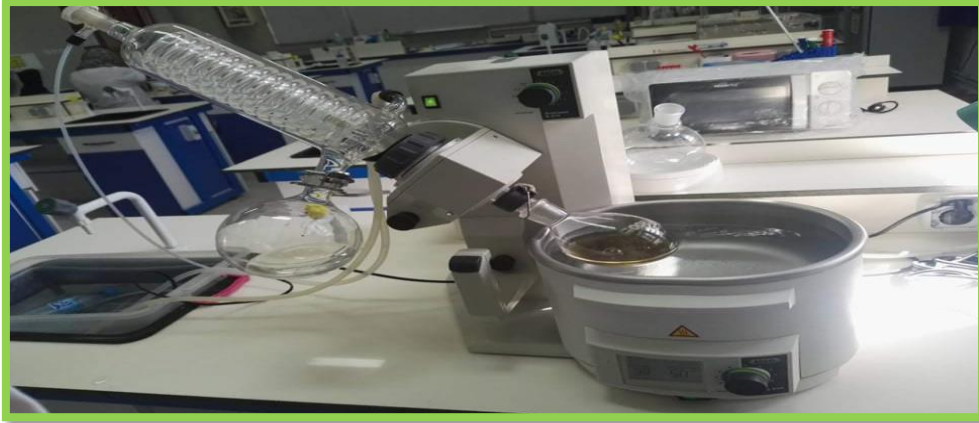
الوثيقة (08): صورة توضح جهاز التبخير الدوراني Rotavapeur
