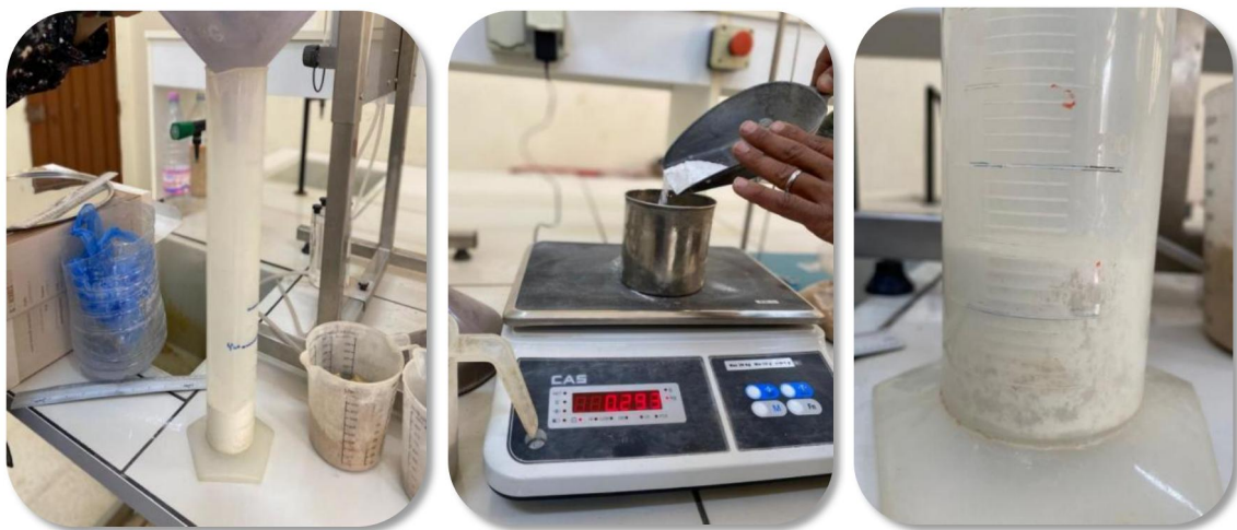
Figure III-8 Essai de Masse volumique apparente de marbre
