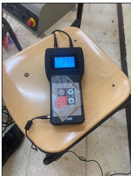
Figure X : Illustration de l'essai d'auscultation sonore (ultrasons)
