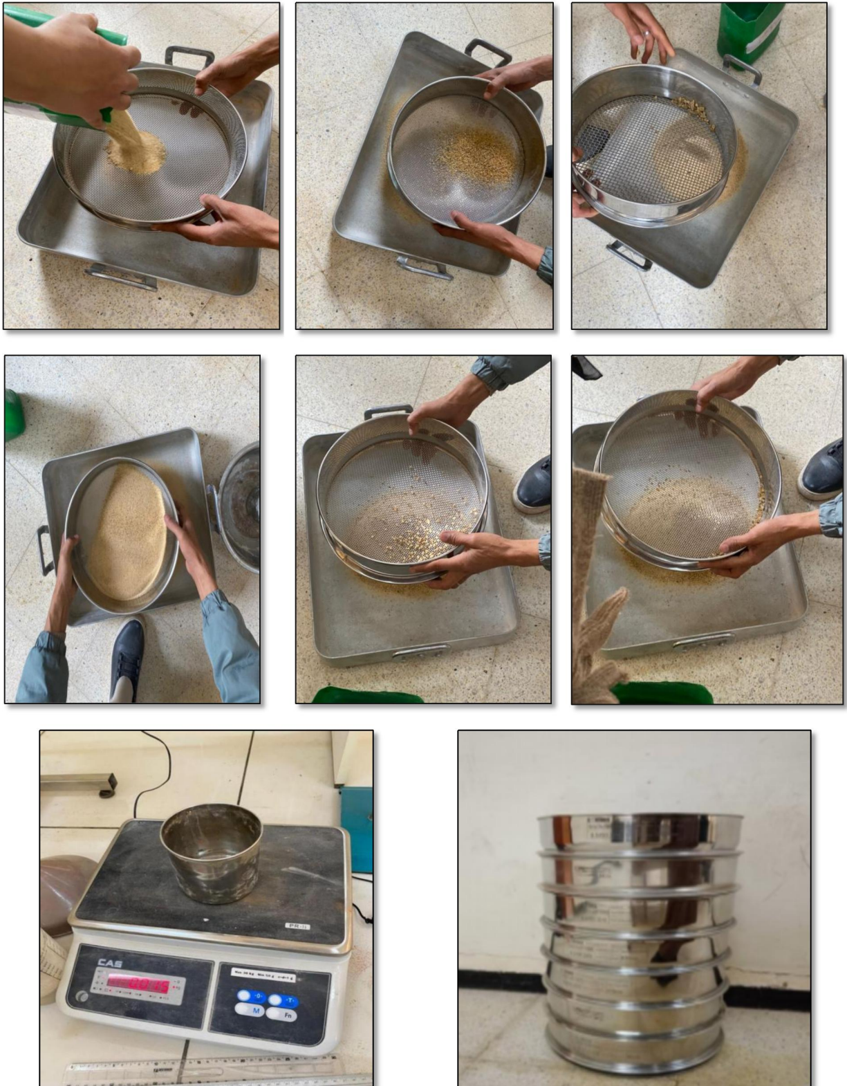
Figure III-10 Essai d'analyse granulométrique
