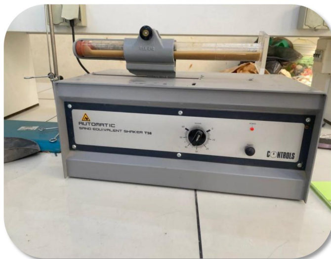
Figure III-2 Essai de l'équivalent de sable
