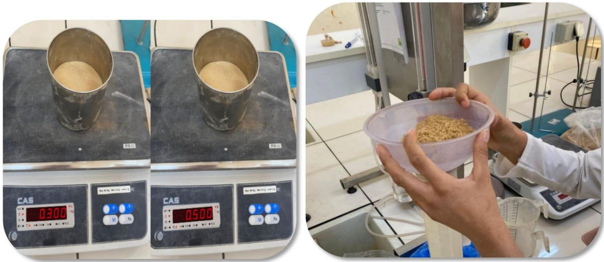
Figure III-6 Essai de la Masse volumique apparente du sable
