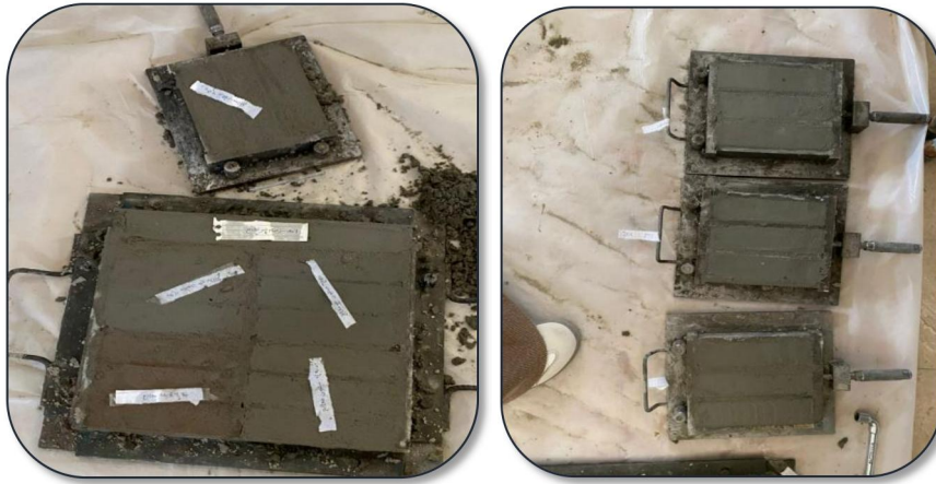
Figure II-8 Phase de moulage et compactage
