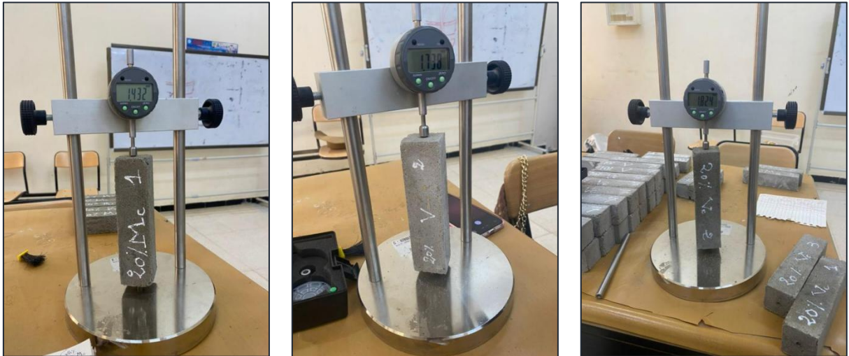
Figure II-10 Éprouvettes prismatiques lors de l'essai de retrait
