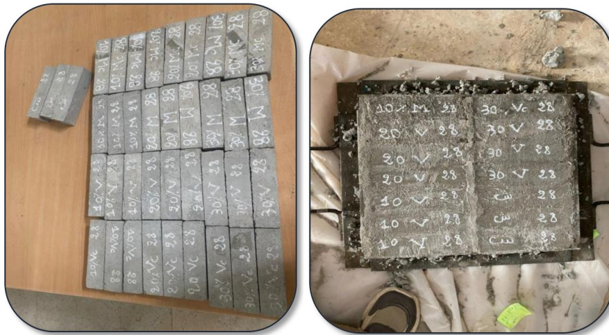
Figure II-9 Éprouvettes prismatiques après démoulage
