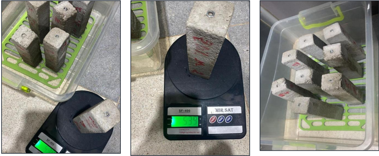
Figure II-12 Immersion partielle des éprouvettes dans le bac d'eau pour l'essai d'absorption capillaire
