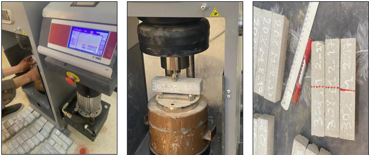
Figure II-13 Éprouvette prismatique placée sur la machine d'essai de flexion
