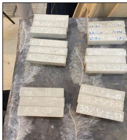
Figure : Éprouvettes conservées à l'air libre
