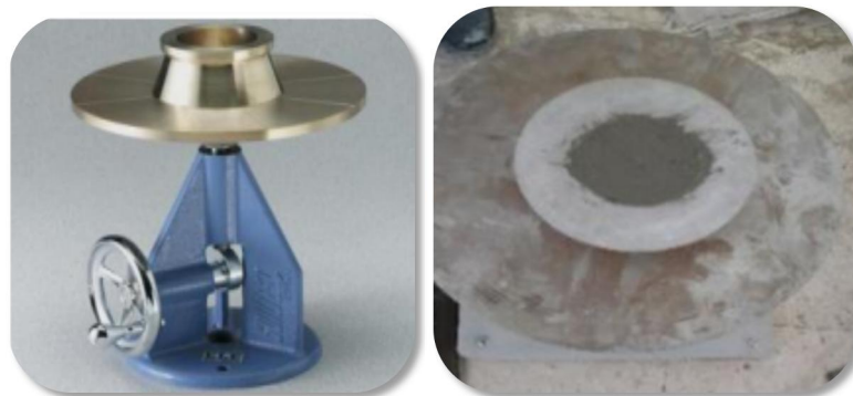
Figure II-2 : Présentation de la table à chocs (Table d'étalement) et mesure de l'ouvrabilité
