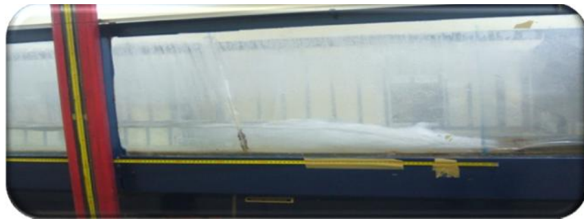
Photo 5.9 : Photographie d'un ressaut hydraulique contrôlé à pente nulle F_1 = 6,63 ; s = 7 cm; L_j = 110 cm; h_2 = 13,7 cm ; \tan(\alpha) = 0
