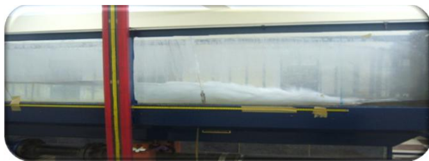
Photo 5.10 : Photographie d'un ressaut hydraulique contrôlé à pente positive F_1 = 8,96 ; s = 17 cm; L_j = 164 cm; h_2 = 20,8 cm ; \tan(\alpha) = 0,01
