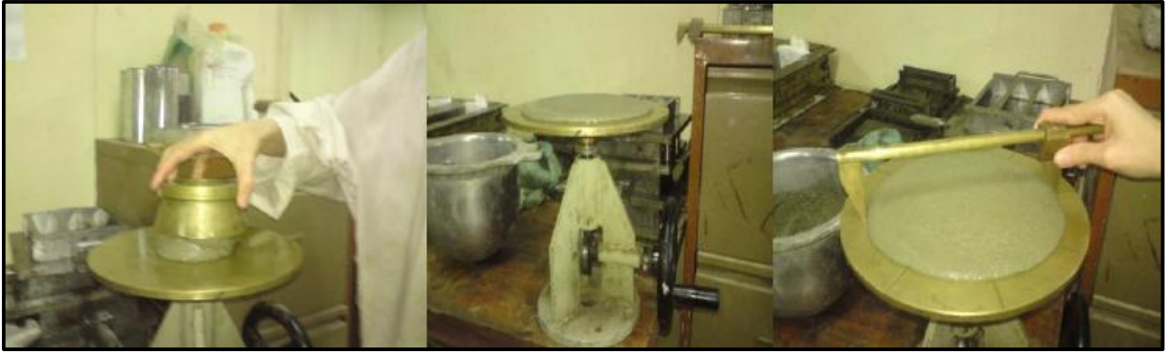
الشكل 1.2: المراحل المتبعة لحساب انسياب الملاط.
