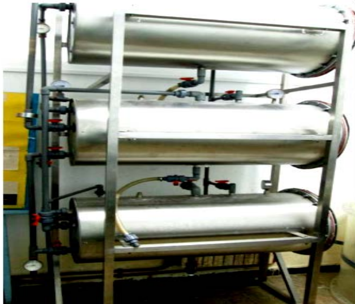
Fig.1.10.b. Distillation à multiples effets
