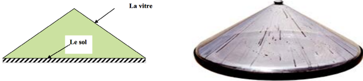
Fig. I.4. Distillateur solaire terre-eau
