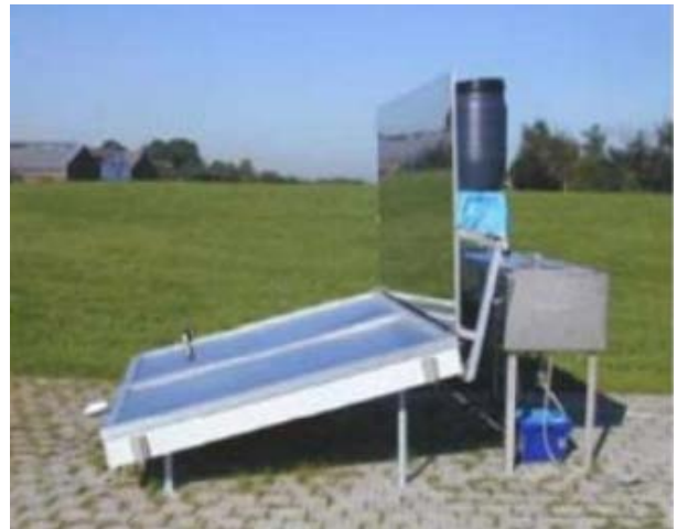
Fig. I.8 Distillateur incliné à matière poreuse noire
