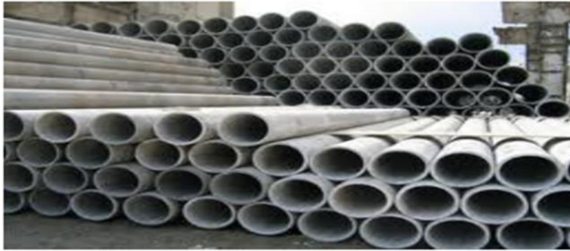
PHOTO III.4 : Conduite en amiante ciment.
