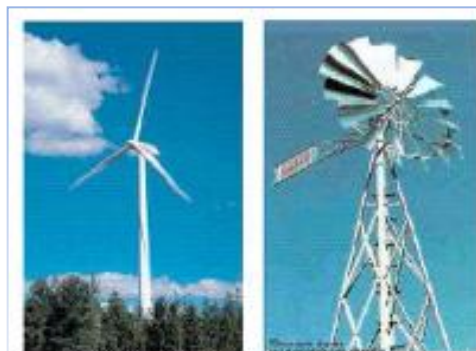
Fig. I. 1 : Technologie éolienne à axe horizontale, [BEL 07].
