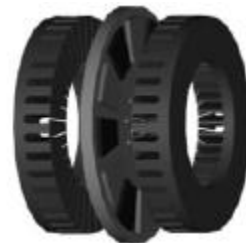
Fig. I. 9 : Machine synchrone à aimants permanents discoïde à double stator
