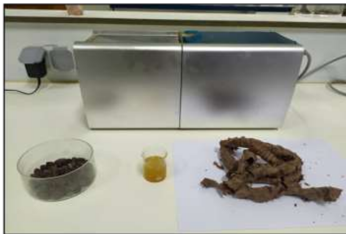
Figure 12: Extraction d'HF de jojoba par Machine de pression à chaud (Photo originale).
