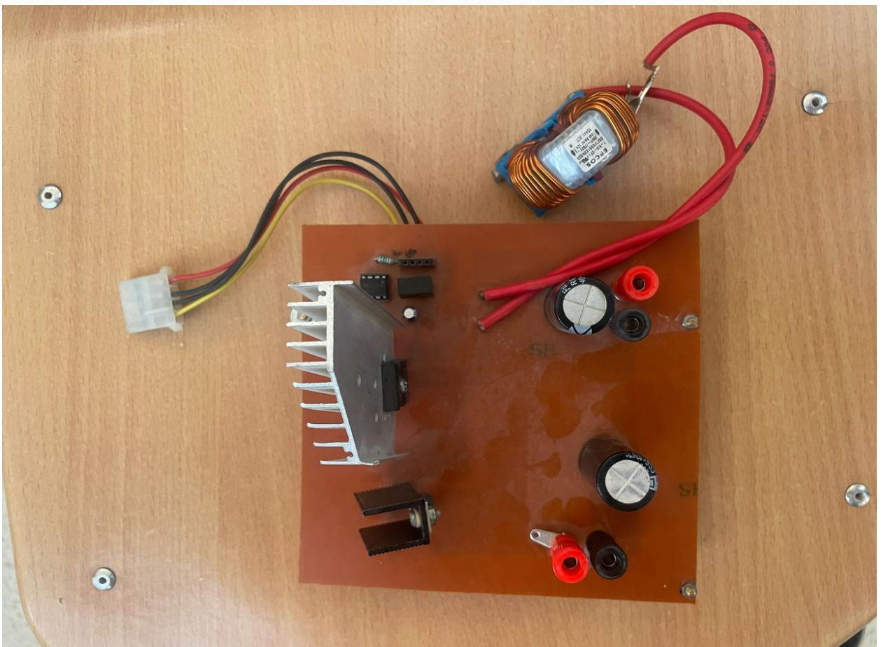
Figure(III-.2) : schema de l'hacheur boost
