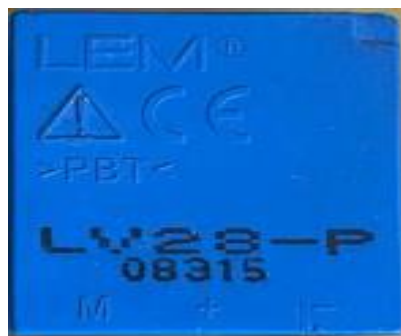
Figure(III-.5) : Capteur de tension (LV 28-P)
