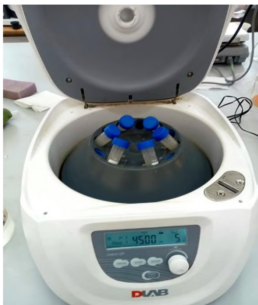
الشكل (15.III): فصل الراسب باستعمال جهاز الطرد المركزي.
