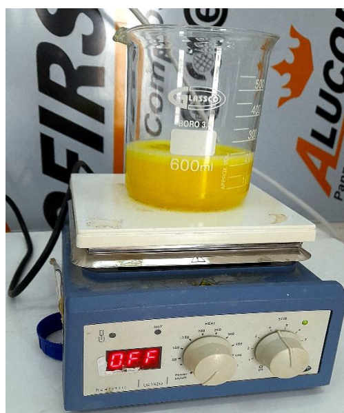
الشكل (11.III): المزيج اثناء تقطير الكركمين و داخل الحمام المائي.
