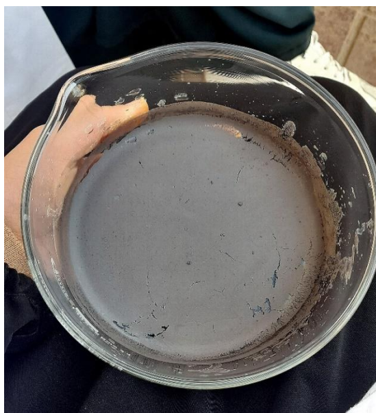
الشكل (17.III): أكسيد النحاس النانوي CuO بعد التجفيف والمعالجة الحرارية.
