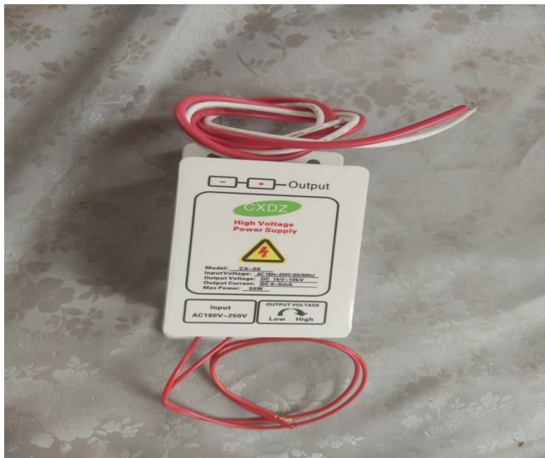
Fig(III-16) - Image de Le générateur de tension continue à haute tension (1 kV à 10kV)
