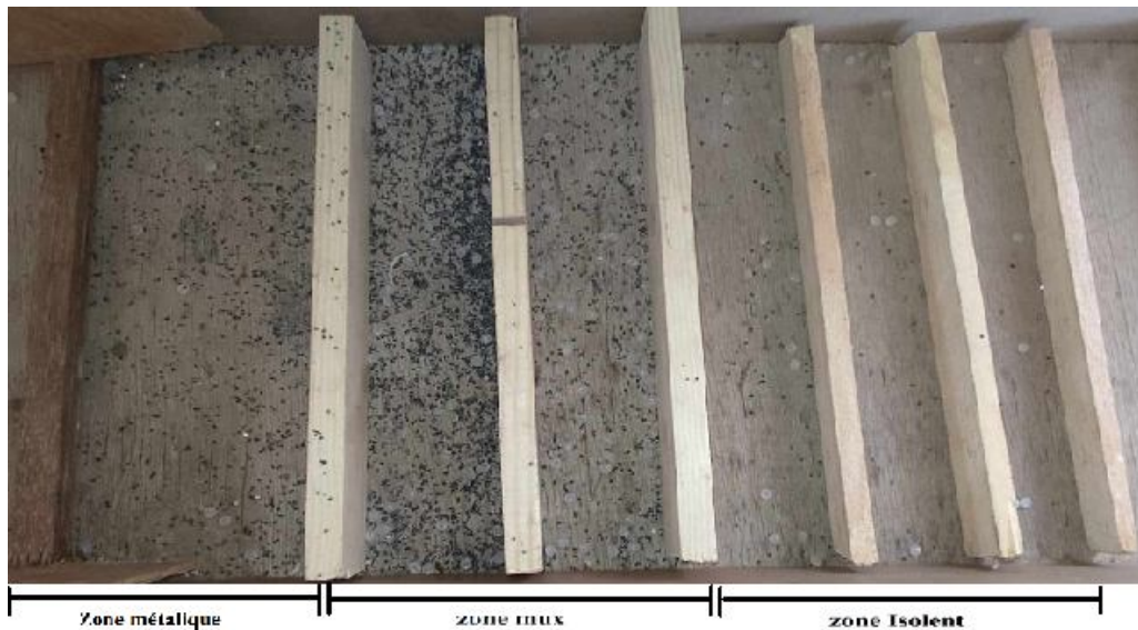
Fig(VI -21)- photo du résultat de la séparation du métal et de PET blanc(LDPE)
