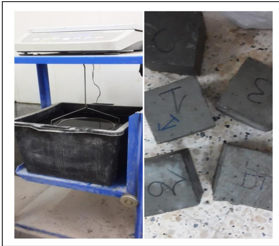
Photo III-10: Eprouvettes de différents bétons destinées à l'essai par pesée hydrostatique
