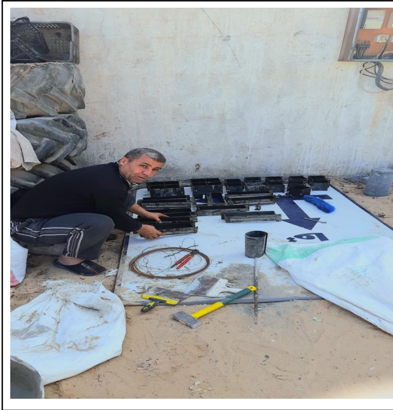
photo III-02: Remplissage des différents moules
