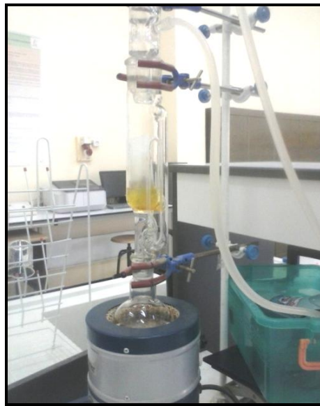
الشكل (4.IV): عملية الاستخلاص في تركيب سوكسلي.
