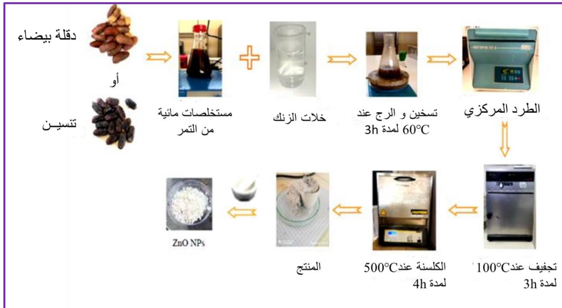
الشكل(II-4): مخطط يلخص خطوات استخلاص (ZnO NPs).
