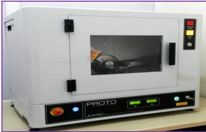
الشكل (9-II): جهاز انعراج الأشعة السينية (DRX) المستخدم.
