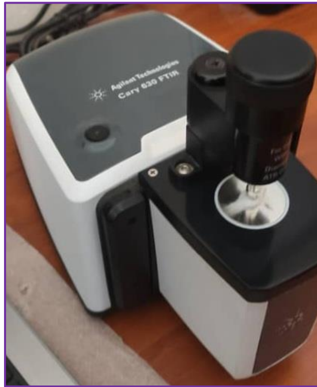
الشكل (6-II): جهاز مطيافية الأشعة تحت الحمراء المستخدم.
