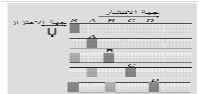
الشكل (5-I): كيفية إنتشار امواج طولية[2].
