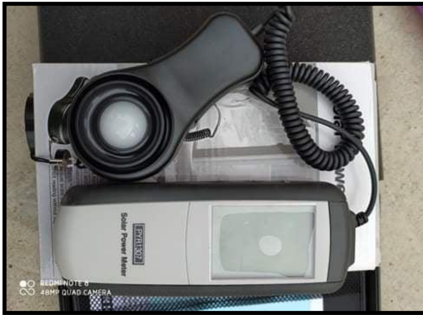
الصورة رقم (3-5): جهاز قياس الإشعاع الشمسى
