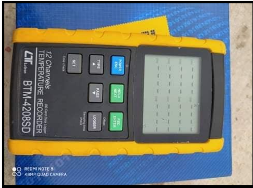
الصورة رقم (3-3): جهاز قياس درجة الحرارة (Temperature Recorder)
