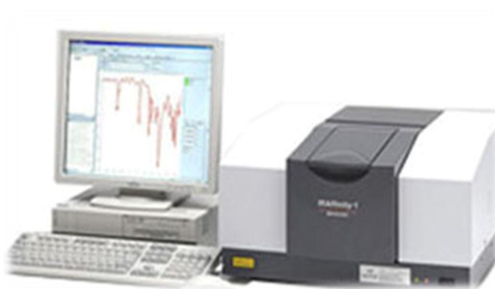
Figure (14) : La spectroscopie à infrarouge à transformé de fourier (IRTF) .
