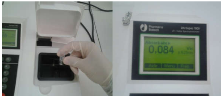
Mesure de la densité optique par le spectrophotomètre.
