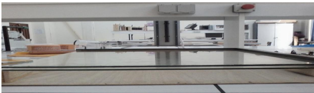
الشكل (7-II): الغطاء الشفاف للاقط شمسي مسطح
