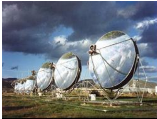
الشكل (2-I): صورة مع رسم توضيحي للاقط شمسي الطبق المركز [8].
