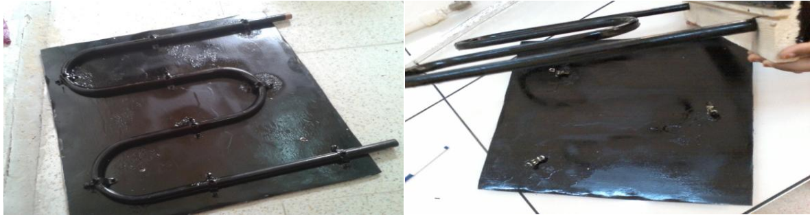
الشكل (3-II): الصفيحة الماصة للاقط شمسي مسطح
