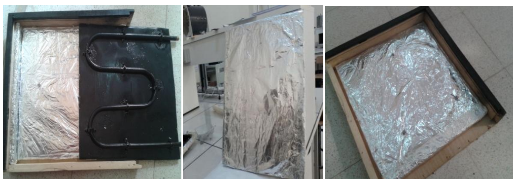
الشكل (6-II): العازل السفلي الذي يفصل بين الصفیحة الماصة والصندوق الخشبي
