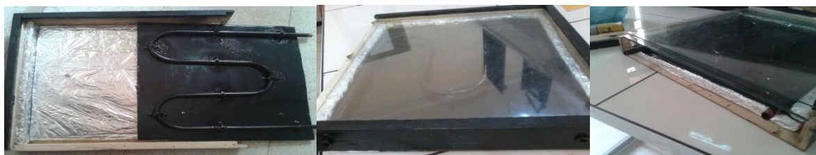
الشكل (8-II): صورة توضح كيفية تركيب اللاقط الشمسي المسطح
