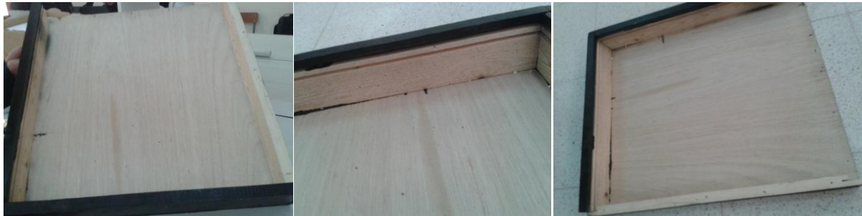
الشكل (2-II): الصندوق الخشبي للاقط الشمسي المنجز
