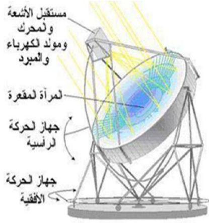
الشكل (2-I): صورة مع رسم توضيحي للاقط شمسي الطبق المركز [8].
