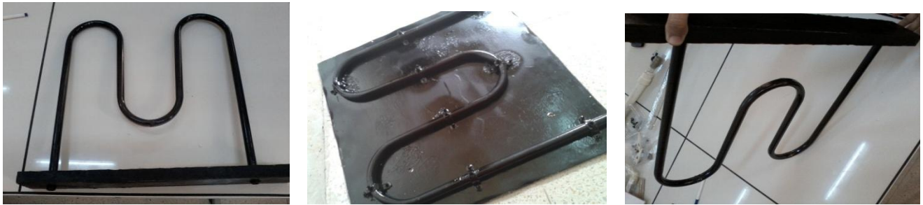
الشكل (4-II): أنبوب النحاس للاقط المنجز
