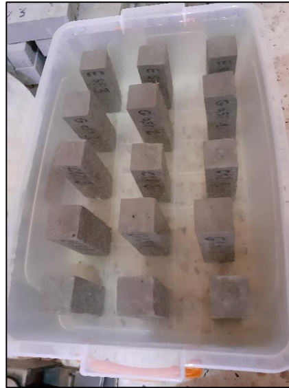
Figure II.12. Essai d'absorption d'eau par immersion totale.
