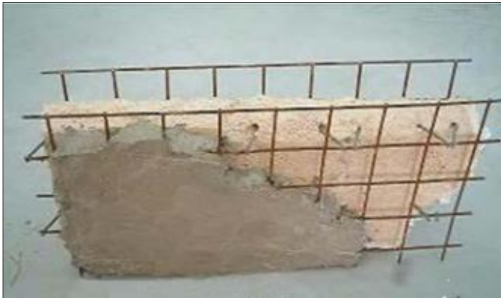
Figure I.9. Panneau 3D en béton de sable projeté [Benaïssa et al., (2008)].
