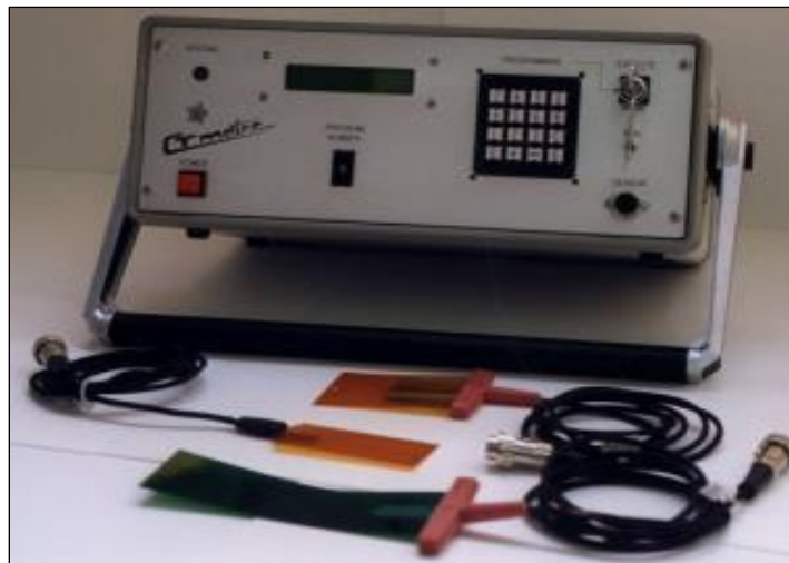
Figure II.13. Dispositif de mesure de la conductivité thermique « CT METRE ».
