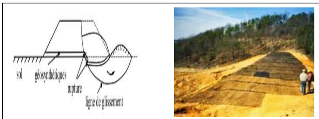
Figure 1.19: une nappe géosynthétique pour une construction d'un remblai [7][9]
