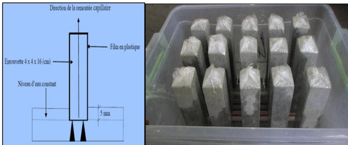
Figure III.12 : Dispositif de l'essai d'absorption d'eau par capillarité.
