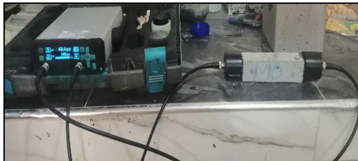
Figure III.14 : Mesure de la vitesse de propagation de sons.
