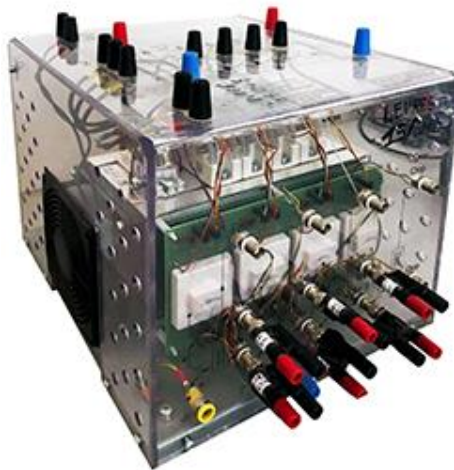
Figure IV-3 : Onduleur de tension à deux niveaux
