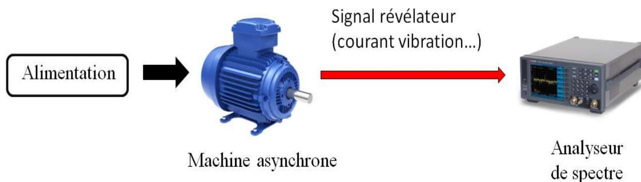
Figure (II.2) : Principe de la surveillance par analyse spectral [KHA11].
