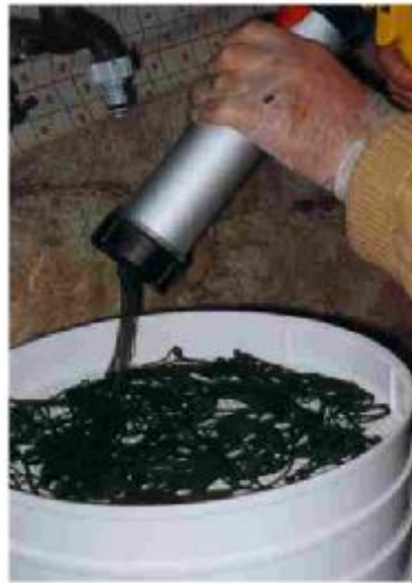
Figure 10 : Extrusion de biomasse pressée, avec pistolet à silicone Sika, sur un plateau de séchoir électrique 1998( Jourdan, 1999) .
