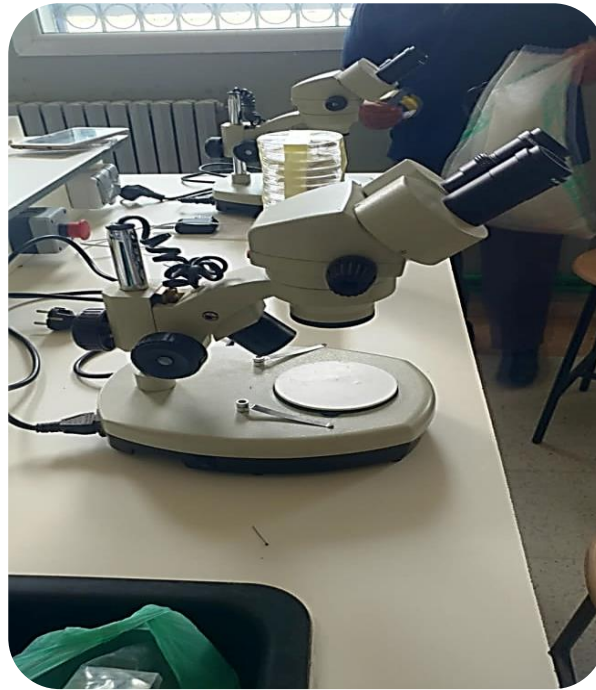
Figure 30 : Loupe binoculaire pour l'examen et le tri des kystes (originale, 2019).
