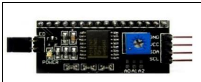
شكل رقم (III-41) صورة شاشة واجهة I2C
